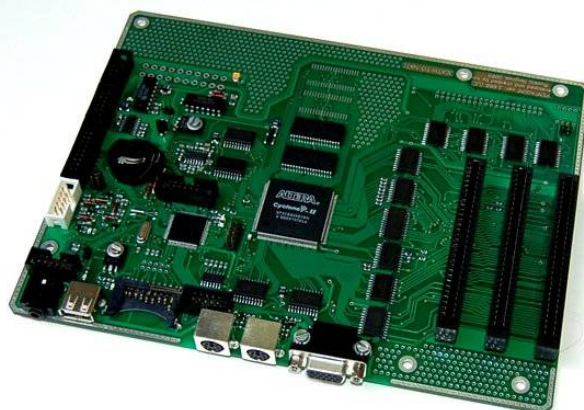
Рисунок 4: Печатная плата “Pentagon” ver.2.666le (2009 г.)
