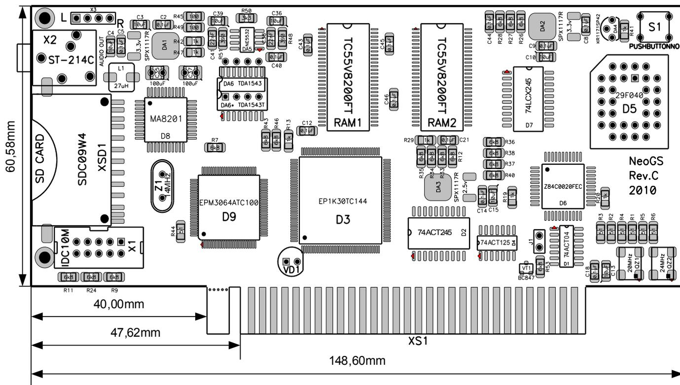
Плата предназначена для установки в слот ZXBUS с шагом контактов 2.54мм. Первый контакт находится слева на лицевой стороне платы (со стороны монтажа деталей, см. рисунок). Плата оснащена направляющим ключом (около первого контакта разъема платы, см. рисунок) для удобной установки в слот. Если ключ мешает установке платы, его можно отломить.
